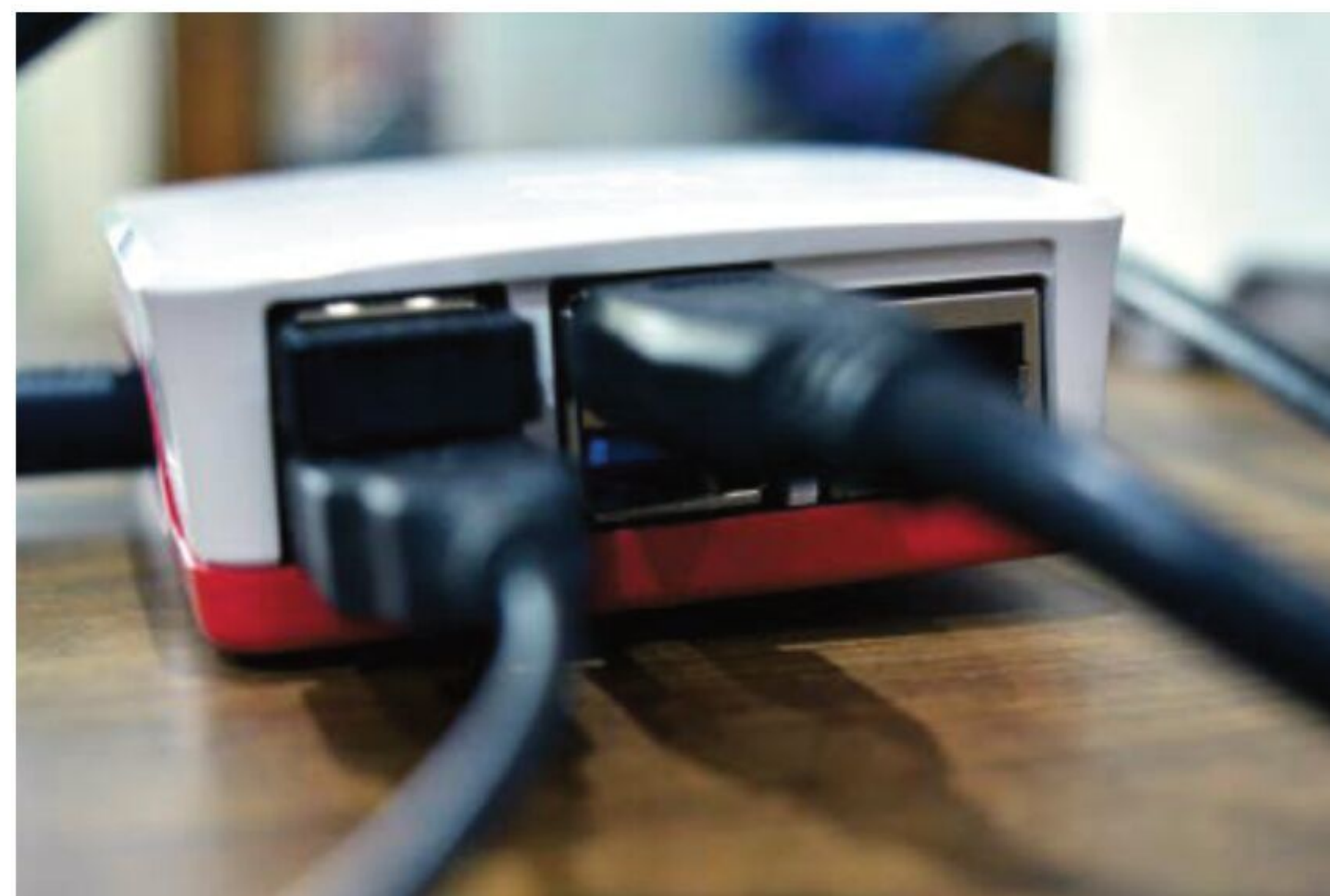
Con quattro porte USB, la Raspberry Pi 4 può gestire sia dispositivi USB 3.0 sia USB 2.0
