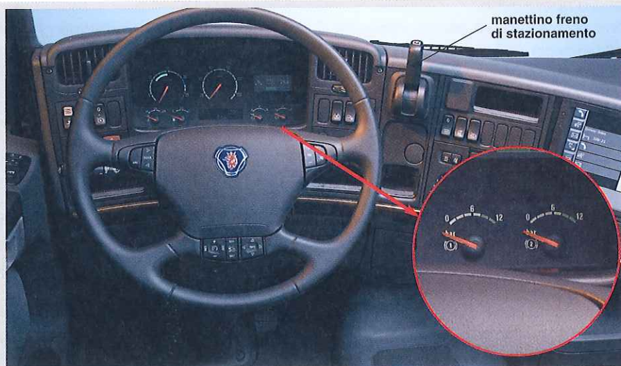
A CRUSCOTTO CON SEGNALE DI PRESSIONE; NEL PARTICOLARE I MANOMETRI RELATIVI AI DUE CIRCUITI FRENANTI (Scania)
